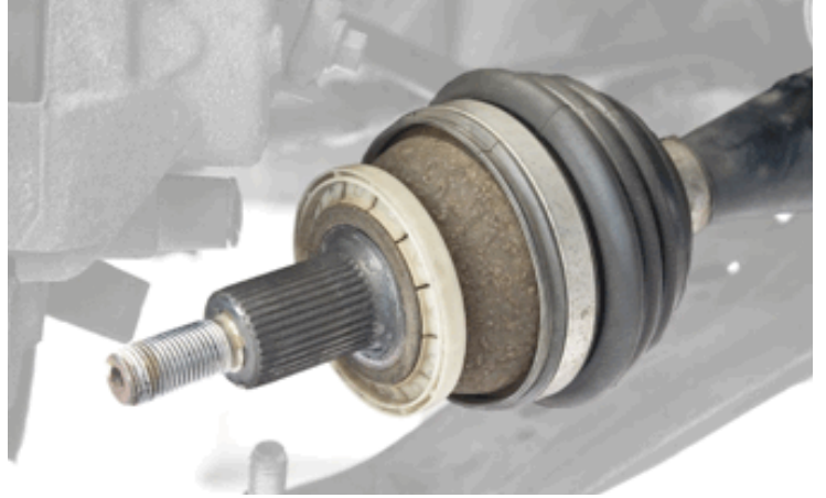
Şekil 1: Sızdırmazlık keçelerinin tasarım ve rengi uygulamaya göre değişiklik gösterebilir.
