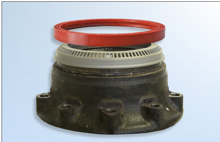
Εικόνα 1: Τοποθέτηση δακτυλίου ABS
