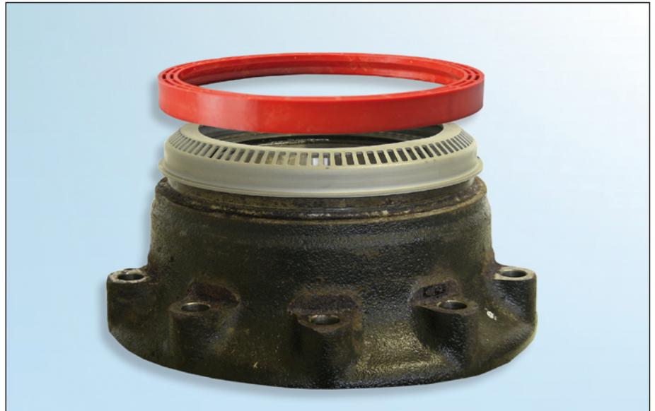
Fig. 1: montaje del anillo ABS
