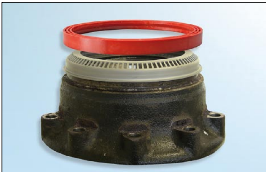
Foto 1: Montaż pierścienia ABS
