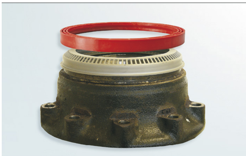
Рис.1: Установка кольца ABS
