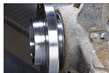
Figur 3: Låseringen skal flugte med styrespindlen
