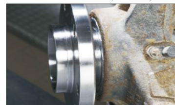
Рис. 3: Убедитесь, что стопорное кольцо встало на посадочное место и располагается заподлицо с поворотным кулаком.
