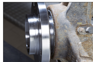
Bild 3: Låsringen måste befinna sig i samma plan som styrspindeln
