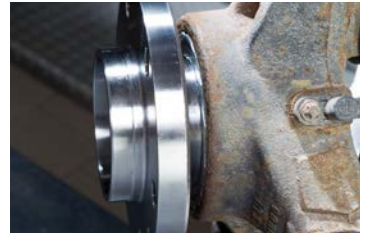
Şekil 3: Kilitleme halkası aks başı ile aynı hizada olmalıdır.
