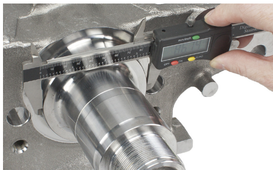
Fig. 2: Pentru a determina care dintre cele trei inele de protecție se va potrivi, trebuie măsurat diametrul locașului garniturii de etanșare
