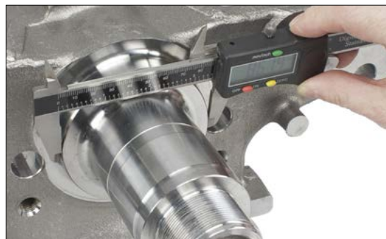
Figur 2: For at afgøre hvilken af de tre beskyttelsesringe, der skal monteres, skal styrespindlens bund måles.
