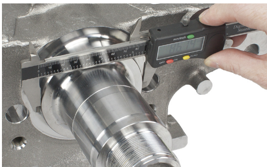
Εικόνα 2: Με σκοπό τη σωστή επιλογή δακτυλίου μεταξύ των τριών που διατίθενται, πρέπει πρώτα να γίνει μέτρηση της διαμέτρου της φωλιάς της τσιμούχας
