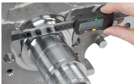
Kuva 2: Sen selvittämiseksi, mikä kolmesta suojaarenkaasta on sopiva, on mitattava tiivisteiden vastepinnan halkaisija
