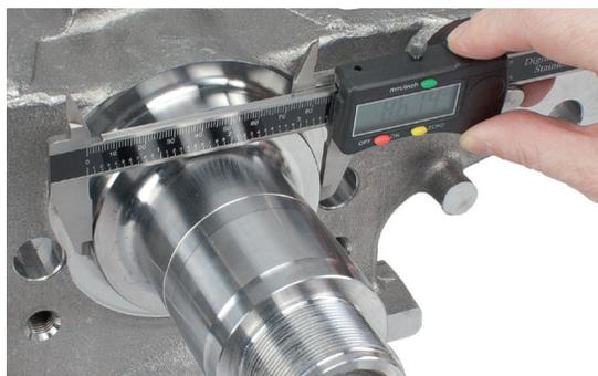
Figura 2: Per stabilire quale dei tre anelli di protezione è quello adatto, è necessario misurare il diametro della sede della tenuta
