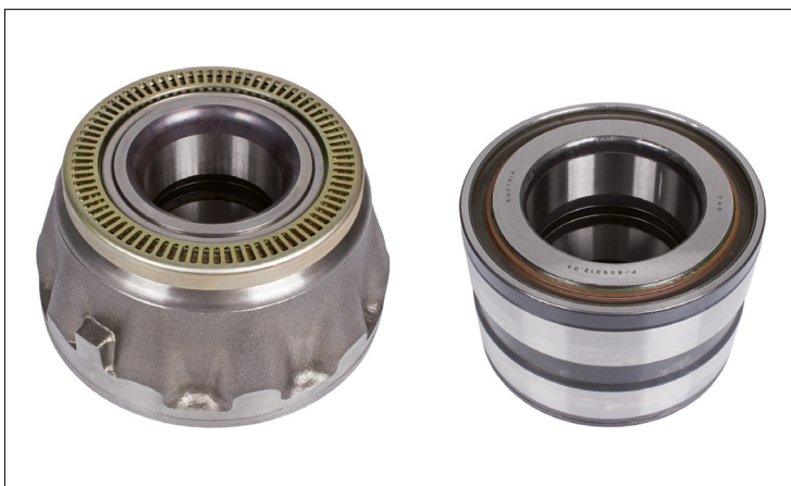
Kuva 1: TAM (trans axle modul) ja THU (truck hub unit)
