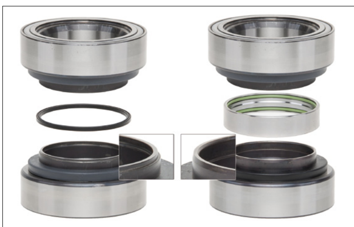
Photo 1: Différences entre le modèle de FAG (à gauche) et celui de l'OES (à droite)
