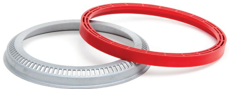
Anillo sensor ABS 434 0497 10 con herramienta especial para montar a presión
