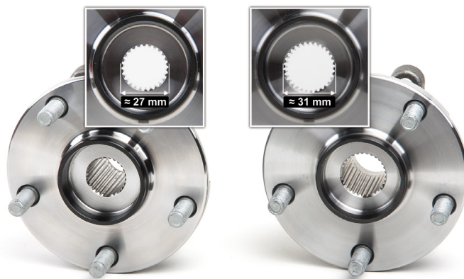
Kuva 2: Puoliakselien kiinnityshalkaisija on erilainen
