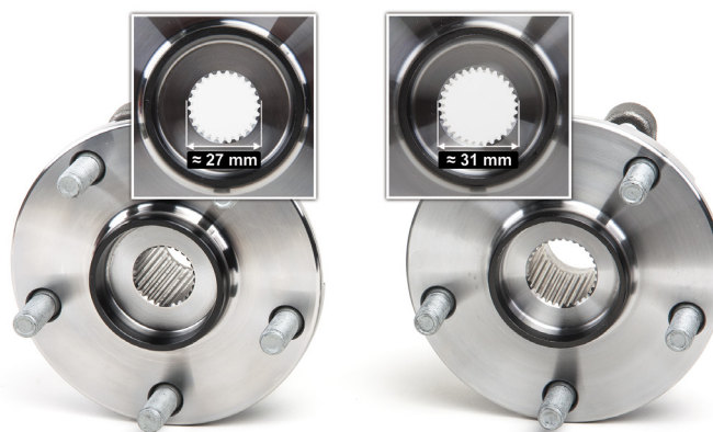
Bild 2: Diametern hos drivknutarnas splines är olika
