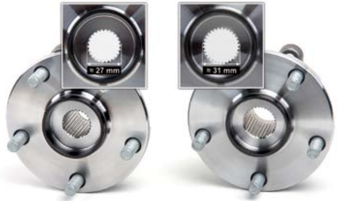
Resim 2: Aks mafsalı frezesi çapı farklıdır
