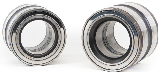
Kuva 1: Truck Hub Unit (pyörän navan laakeriysikkö) tiivisterenkaalla (vasemmalla) tai pyörästetyllä reunalla (oikealla) laakerin sisärenkaassa
