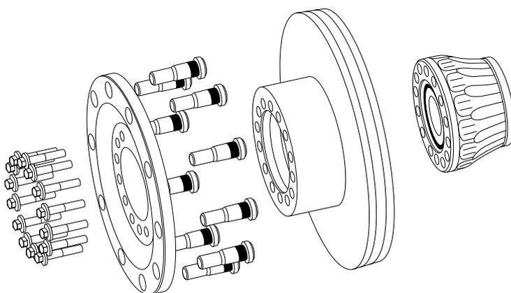
Рис. 1: Для осей, маркированных номером S63U, в дополнение к ступичному модулю, должны заменяться тормозной диск, крепление колеса, резьбовые шпильки и гайки.
