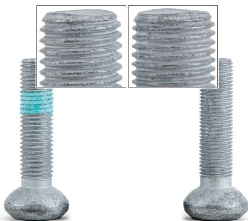
Fig. 1: Linkerschroef: M12x1,5 Rechterschroef: M12x1,25
