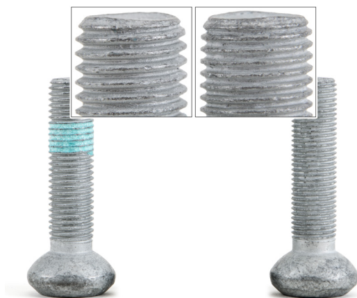
Bild 1: Vänster skruv: M12x1,5 Höger skruv: M12x1,25
