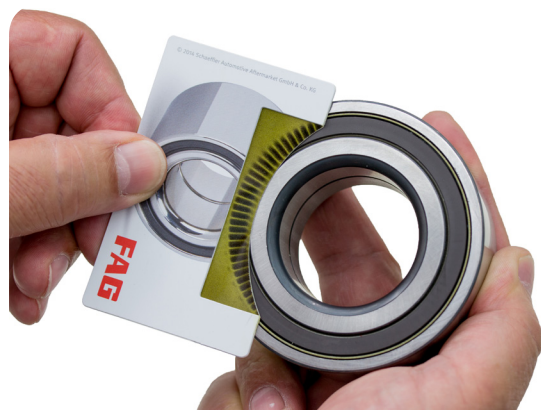
Fig. 1: Met de encoderkaart kan de montagezijde van een meerpolige encoder worden vastgesteld. Bij passieve encoders werkt dit niet
