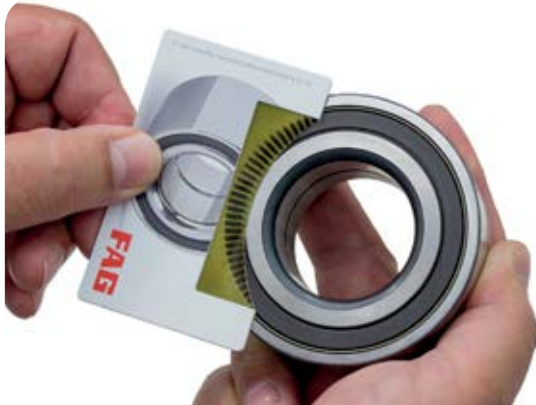
Resim 1: Çok kutuplu bir kodlayıcının kurulum tarafını belirlemek için kodlayıcı kart kullanılabilir. Pasif kodlayıcılarla, bu işe yaramaz.
