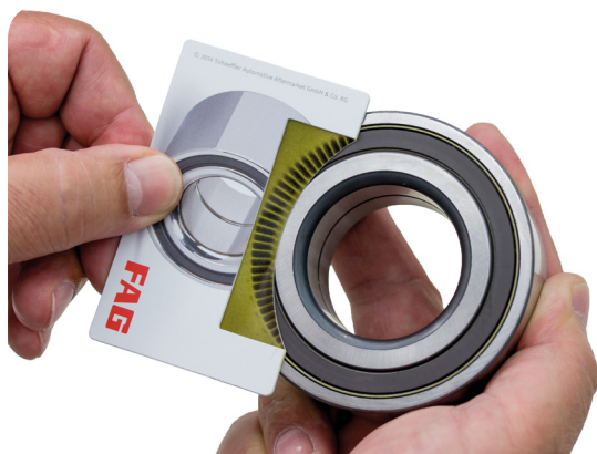
Рис. 1: Диагностическая карточка может использоваться для определения стороны установки подшипника. С пассивными кольцами, такая проверка не действует.
