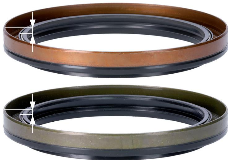
Fig. 2: El labio obturador del retén suministrado (arriba) difiere sólo ligeramente de la versión original instalada (abajo).
