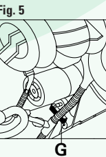
FIGURA 4 Controllare il corretto allineamento delle tacche di fase E ed F. FIGURA 5 Inserire l'apposito attrezzo di bloccaggio del volano G.
