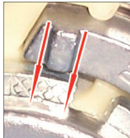
Fig. 5: Ambele creștături sunt în afara suprafeței decupate (săgeți). Reglaj incorrect!
