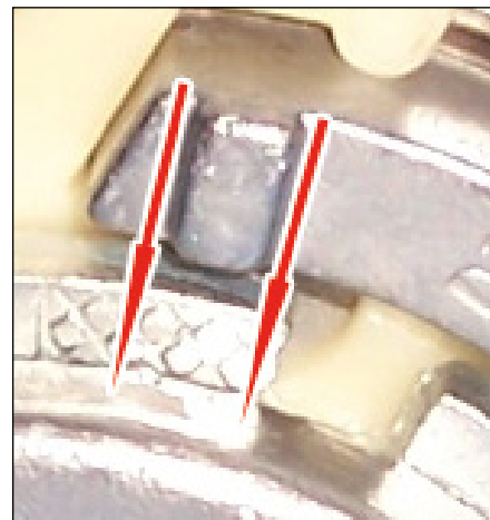
Obrázek 5: Obě strany ukazatele jsou mimo výřez (šipky). Nastavení je nutné korigovat!
