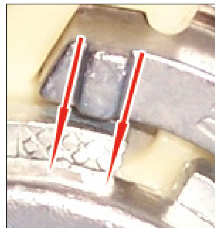
Figur 5: Begge indikatorkanter er uden for udstansningen (pile). Indstillingen skal korrigeres!
