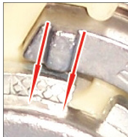
Kuva 5: Osoittimen molemmat reunat ovat leikkauksen ulkopuolella (nuolet). Asetusta on korjattava!
