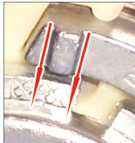
5. ábra: Mindkét tüske a bevágáson kívül áll (nyilak) A beállítást módosítani kell!
