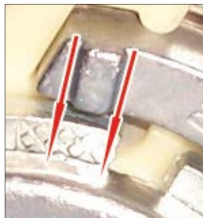
Рис.5: Обе метки в стороне от выреза (показана стрелками) Настройка должна быть скорректирована!
