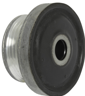
Fig. 1: Partea din spate a fuliei de alternator cu amortizarea vibrațiilor
