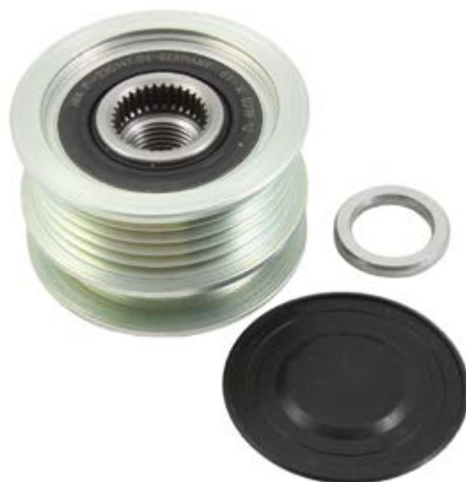
Рисунок 2: 535 0116 10 - шкив генератора с обгонной муфтой INA
