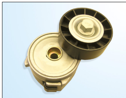
Fig. 1: Rullens kørende overflade er lavet af plast
