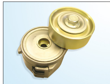
Slika 2: Obodna dodirna površina kolotura od metala
