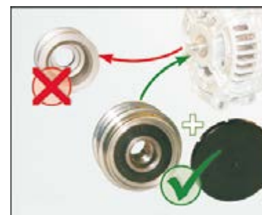
Рис. 2: Замена шкива генератора с обгонной муфтой
