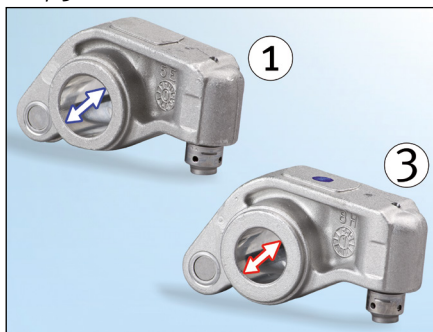
Imagine 2: Diametrul culbutorului este mai mare pe partea de admisie (1)
