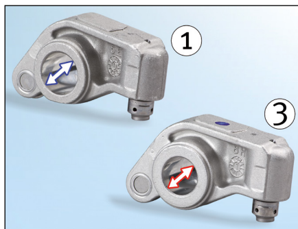
Obrázek 2: Vahadlo sání (1) má větší průměr
