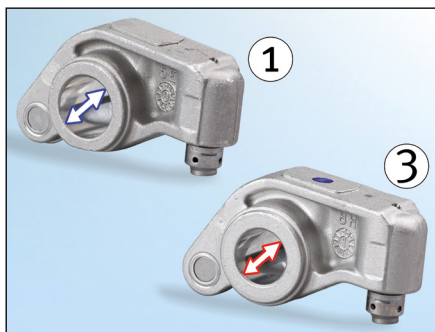
Bild 2: Sugsidans vipparm (1) har större diameter
