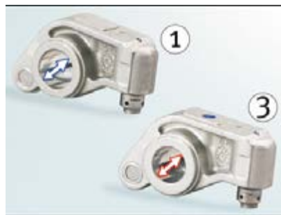
Рис. 2: Диаметр коромысла больше со стороны впуска (1)
