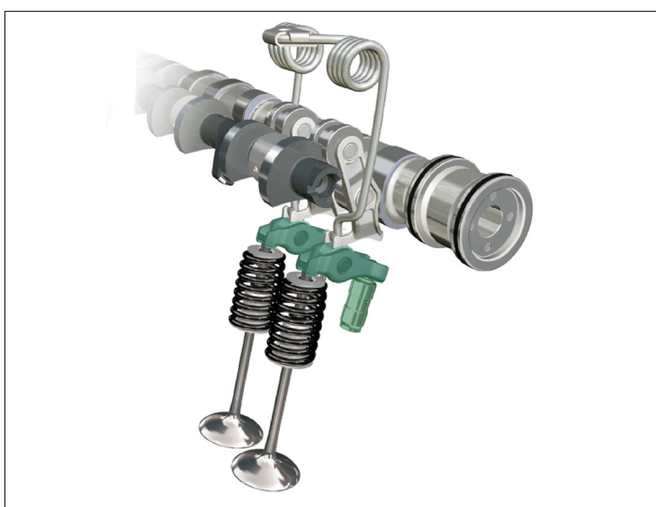
Figur 1: Oversigt over BMW Valvetronic
