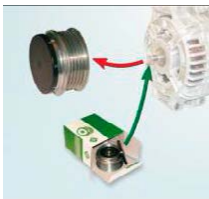
Рис. 1: Рекомендация: замените шкив генератора с обгонной муфтой.
