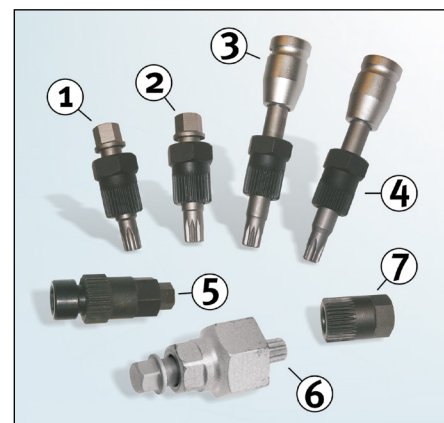
Imagine 5: Uneelte speciale necesare pentru demontarea și montarea diferitelor role pentru transmisie cu roată liberă
