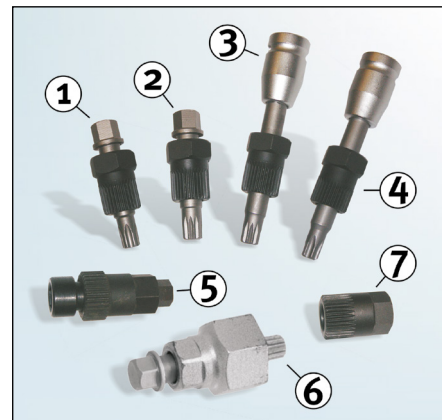
Figur 5: Nødvendige specialværktøjer til afmontering og montering af forskellige friløbsremskiver
