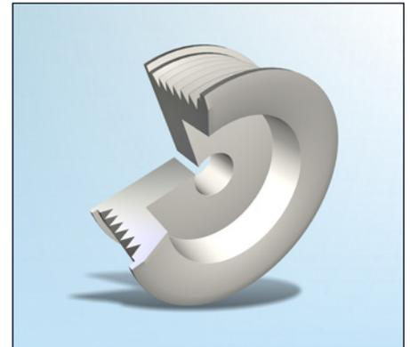
*Fig. 2: Polea rígida*
