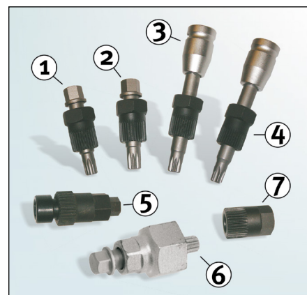
Kuva 5: Erialaisten yhdensuuntaisten hihnapyörien irrotukseen ja asentamiseen tarvittavat erikoistykäkalut
